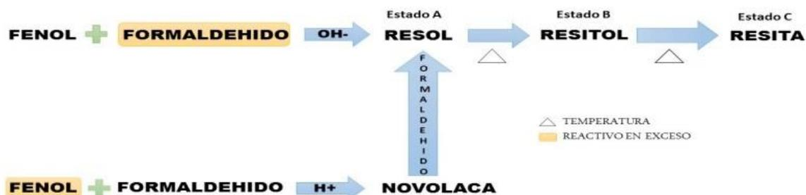
Ilustración 10 Obtención del resol y novolaca
