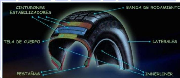
Ilustración 5 Esquema de un Neumático
